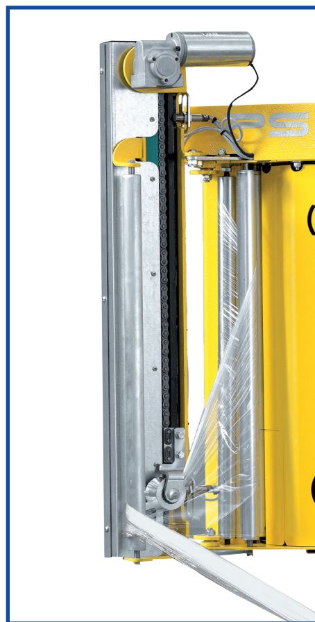
IT_ Sistema a corda: Permette di ridurre l'altezza del film formando un cordone che assicura una più efficiente stabilizzazione del carico. EN_ Roping System: Reducing the film width to form a rope to ensure more effective load stabilisation. FR_ Systeme permettant de réduire la laize du film en formant un cordon qui assure une meilleure stabilisation de la charge. DE_ Schnurrvorrichtung: Reduzierung der Folienbreite zur Schnur um eine bessere Stabilisierung der Ladung zu gewährleisten. ES_ Sistema de Cordón. Permite reducir la altura del film formando un cordón que asegura con mas eficacia la estabilidad de la carga.
