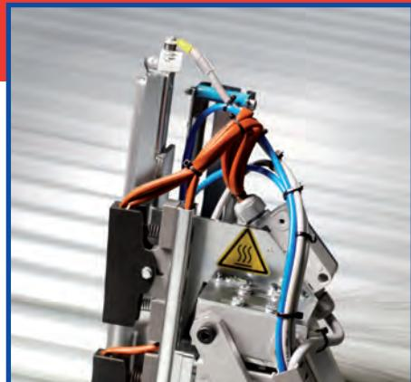
**IT** Sistema saldatura del film estensibile autoregolante per qualsiasi dimensione del pallet.
